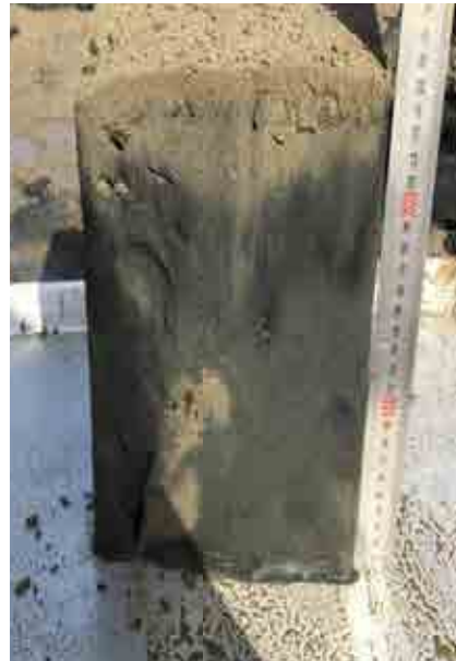
〈그림 4-60〉 백합동 정점 2에서 주상퇴적물 현황을 파악하는 장면(퇴적물 단층의 색상에 따라, 산화층, 산화환원 불연속층 및 환원층을 구별)
