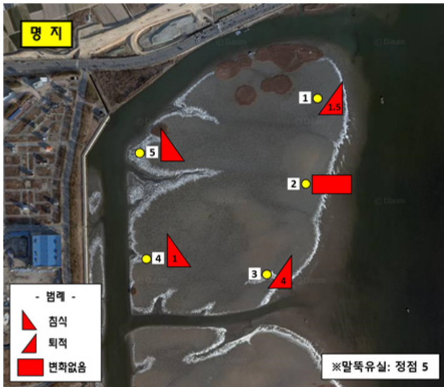
〈그림 4-63〉 명지 지역의 조사 정점 및 퇴적량 변화 (침식 및 퇴적 표시 내 숫자 : 퇴적 및 침식된 높이(단위:cm))
