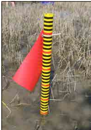
<그림 VII-2> 퇴적량을 측정하기 위하여 맹금머리에 설치된 말뚝의 모습 (빨강색 표기: 10cm; 노란색 및 검정색: 1cm)
