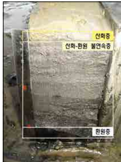
<그림 VII-3> 을숙도 정점에서 주상퇴적물 현황을 파악하는 장면(퇴적물 단층의 색상에 따라, 산화층, 산화환원 불연속층 및 환원층을 구별)
