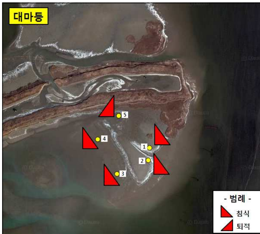
<그림 VII-7> 대마등 지역의 조사 정점 및 퇴적량 변화(침식 및 퇴적 표시내 숫자: 퇴적 및 침식된 높이(단위:cm))
