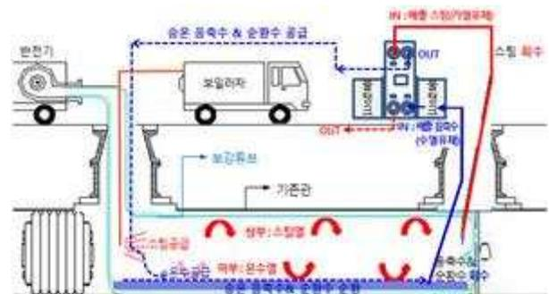
[그림 1] 물순환 경화장치를 이용한 경화/양생 개념도
