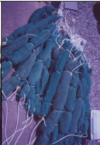
사진-2 폐어망Media(원통형), 설치장소 : 한양빌라, 동백섬, 남홍아파트 외 단 독정화조 다수
